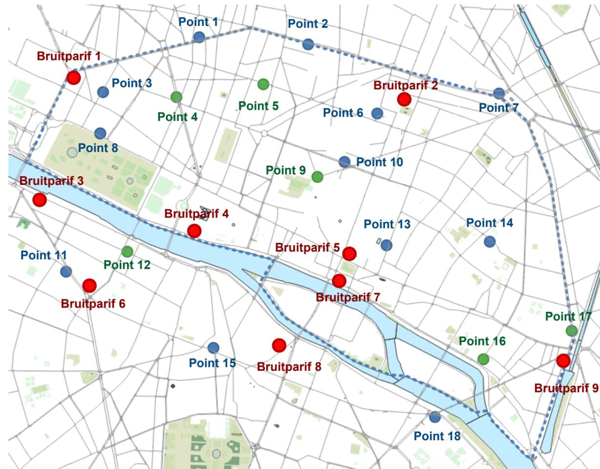
Les mesures de caractérisation sonore du projet ont été réalisées à une hauteur de 1,5m pour les mesures mobiles et à une hauteur variable pour les mesures fixes (3 à 8m). Elles ont été réalisées aux emplacements indiqués ci-dessus.
