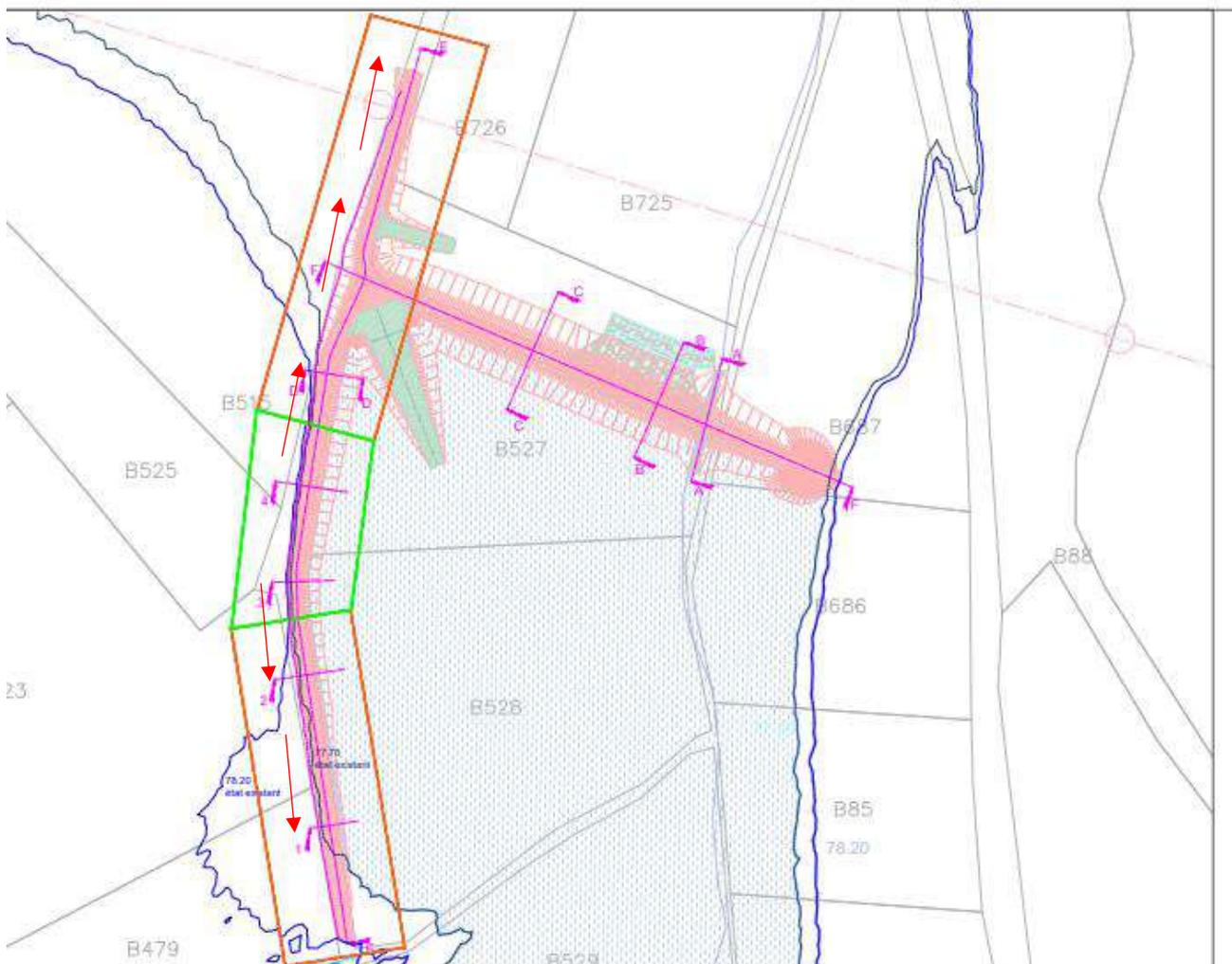
Figure 23 : Ecoulement des eaux pluviales en pied de digue (plan masse)
