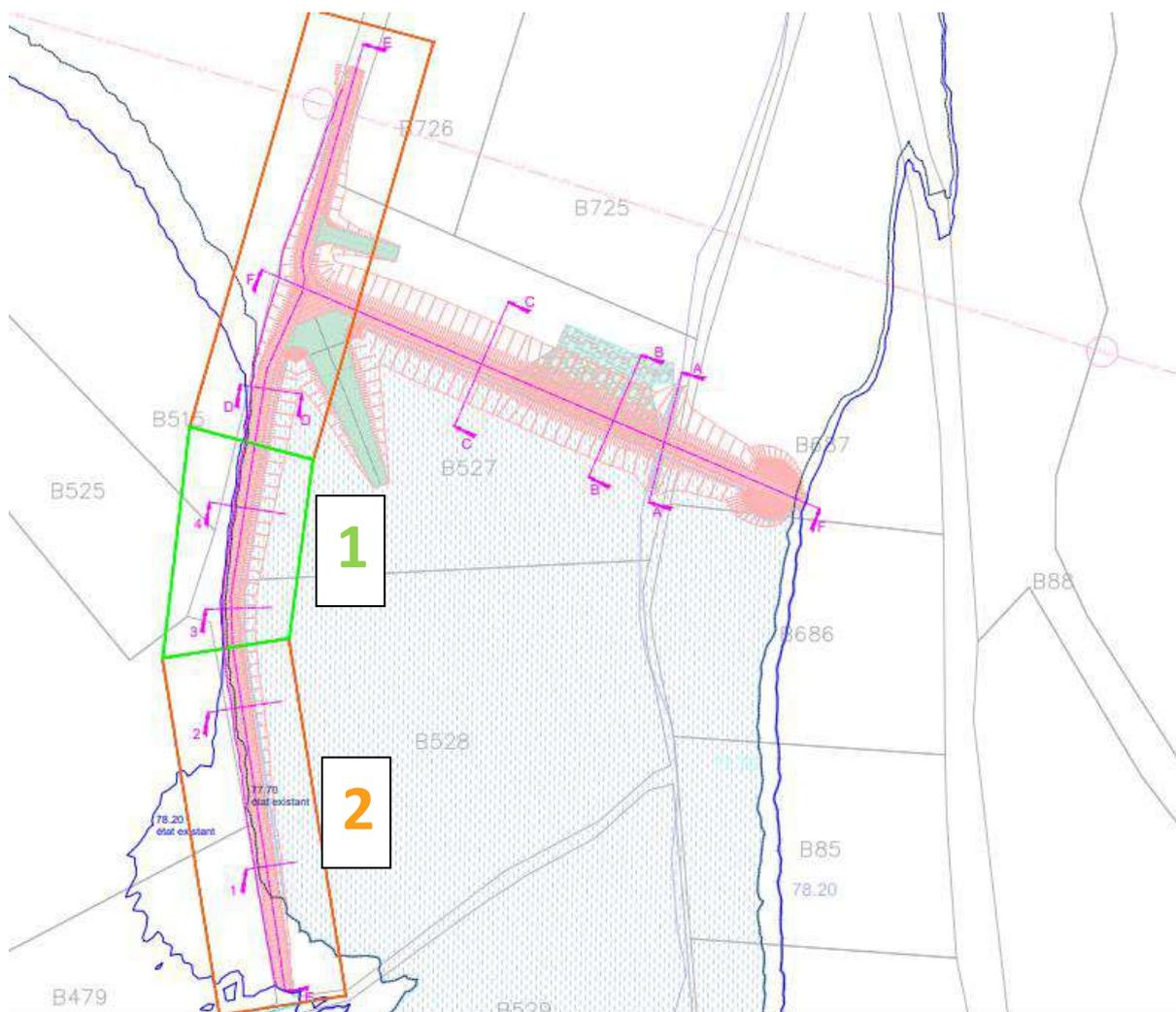
Figure 28 : Plan de la surinondation maximale en cas de suppression de la digue sud
