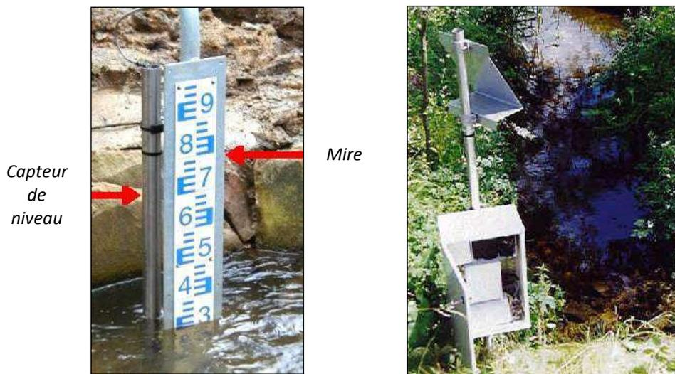
Figure 125 : Exemple de capteur associé à une mire – exemple de centrale d'acquisition
