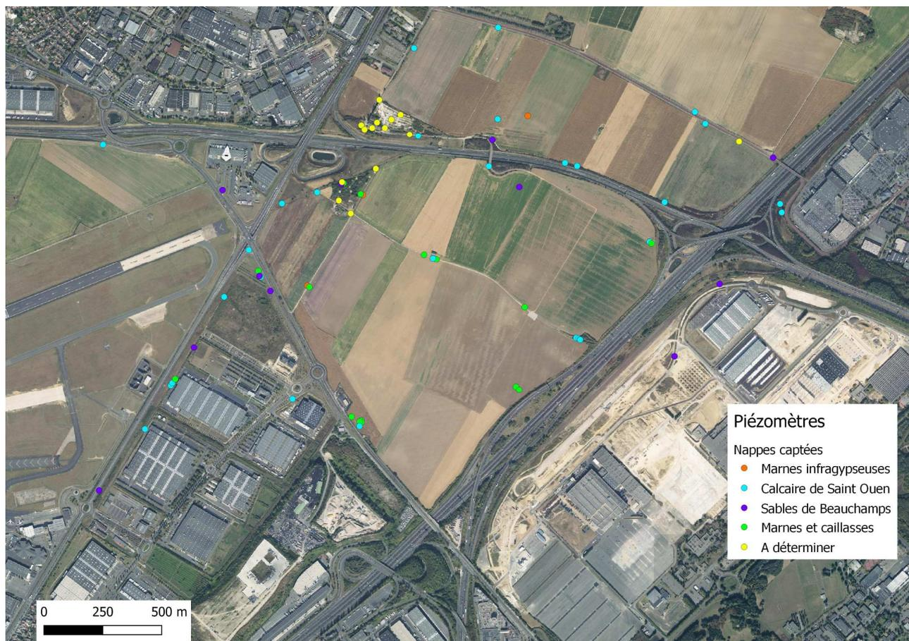
Figure 7 : Carte de localisation des piézomètres en fonction du type de sondage (piézomètres issus des études Abrotec/Althea, Geolia, Société du Grand Paris et Antéa/Tesora) - (la formation géologique majoritairement captée est indiquée, sachant que les crépines de nombreux piézomètres sont à cheval sur deux formations).
