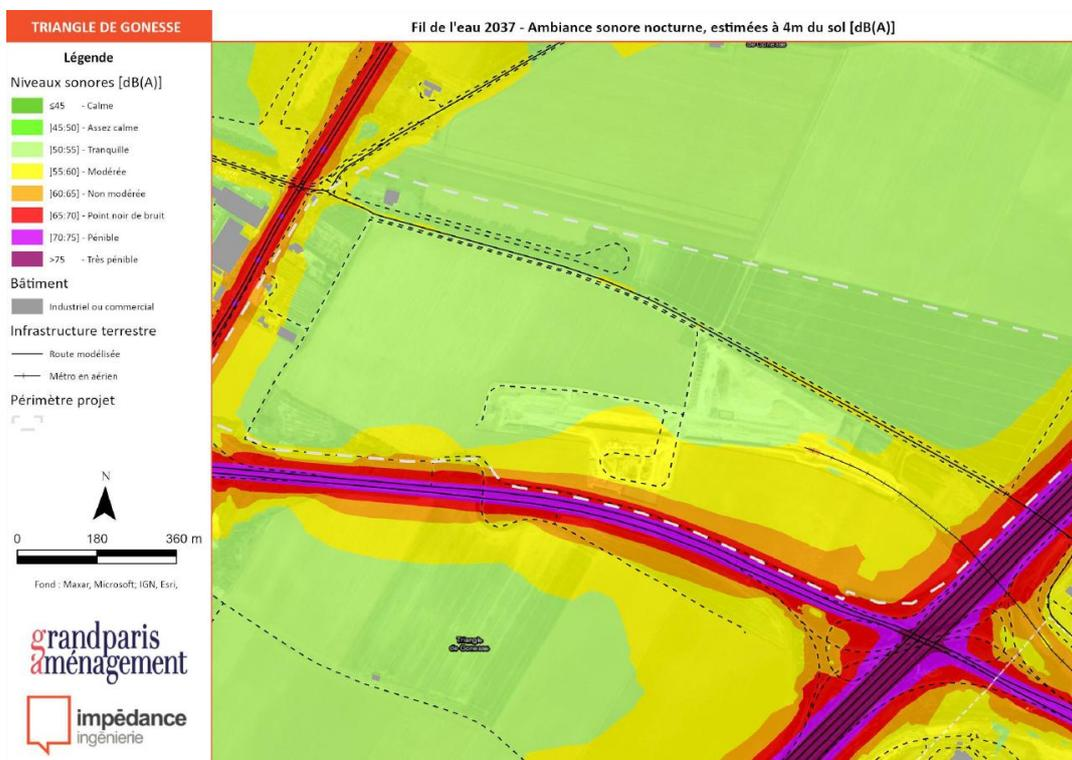
Figure 13 Ambiance sonore nocturne calculée à 4 mètres du sol en situation initiale 2023 (Source : Impédance 2023)
