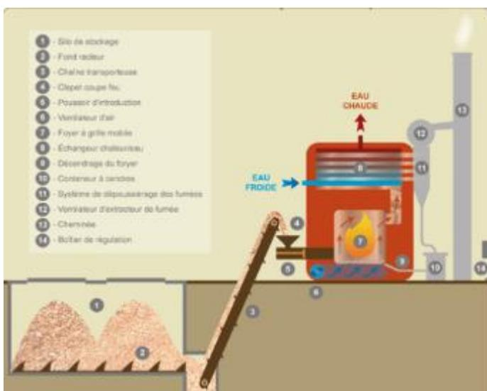
Figure 24 : Schémas de fonctionnement chaudière biomasse
