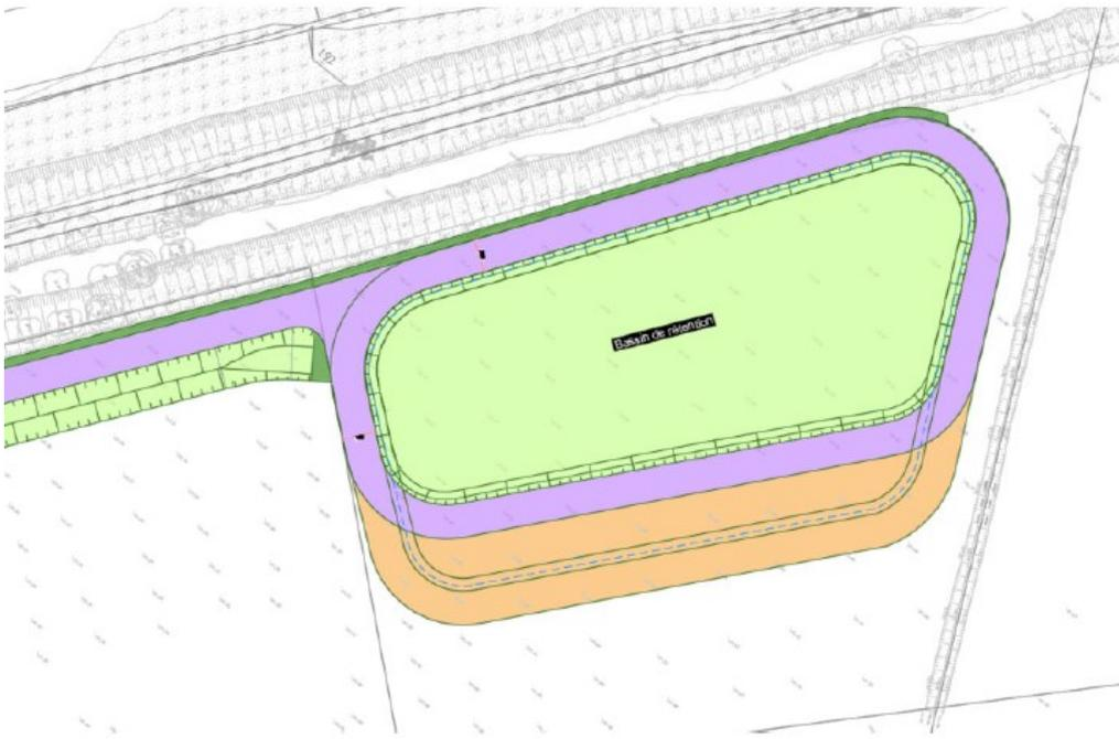
Figure 52 : différence de dimensionnement du bassin entre vingtennale et cinquantennale
