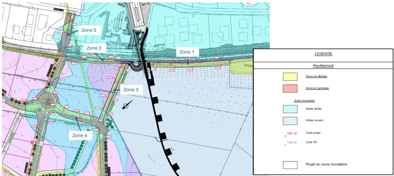
Figure 56 : Déblais et remblais liés à la réalisation des voiries en zone inondable
