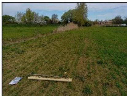
Deux sondages (S23 et S24) ont été réalisés dans le secteur situé tout au nord de la zone d'étude où la mise en place d'un bassin de rétention est prévue. Il s'agit de fluvisols rédoxiques (traces d'hydromorphie qui débutent à entre 50 et 80 cm de profondeur) situés dans un secteur souvent soumis à des engorgements en eau, vu la faible pente et le caractère imperméable du substrat. Cependant, ces sols ne sont pas caractéristiques de zones humides.
