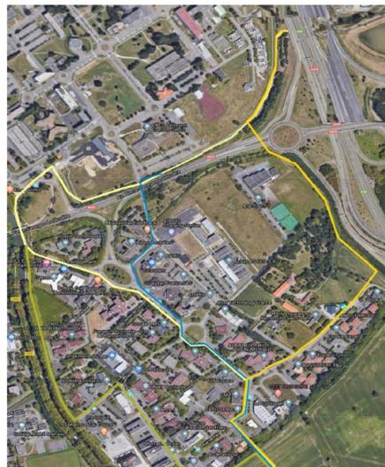
Les tracés proposés pour le déploiement du réseau de chaleur – et plus spécialement le tracé optimal le long de l'avenue de l'Europe - vont coïncider avec le projet de Connexion Ligne B porté par Tisséo concrétisé par le prolongement de la ligne de métro actuelle le long de l'Avenue de l'Europe.
