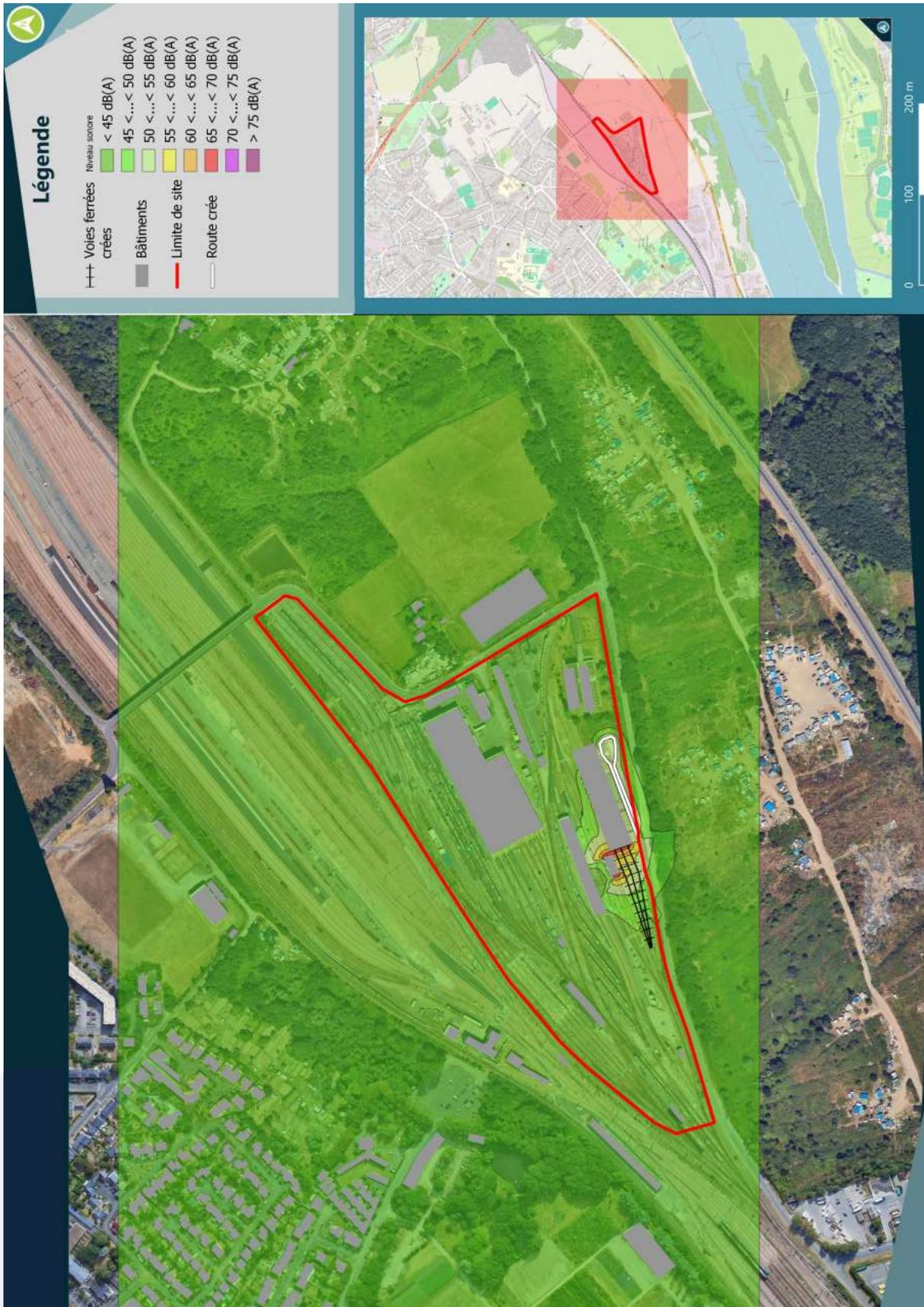
Figure 24 - Evaluation du niveau sonore généré par le projet dans son environnement à une hauteur de 1,50m.
