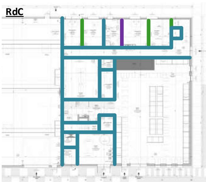
Figure 17 - Repérage des séparatifs intérieurs acoustiques au RdC.
