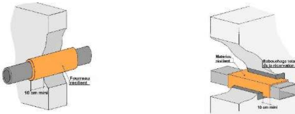
Figure 9 - Schémas de principe de la mise en œuvre des gaines de ventilation en traversée de paroi
