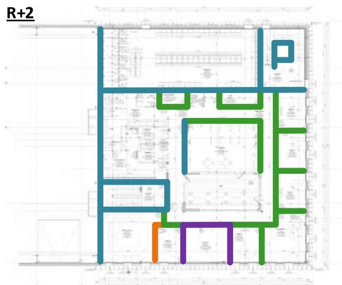
Figure 18 - Repérage des séparatifs intérieurs acoustiques aux R+1 et R+2.
