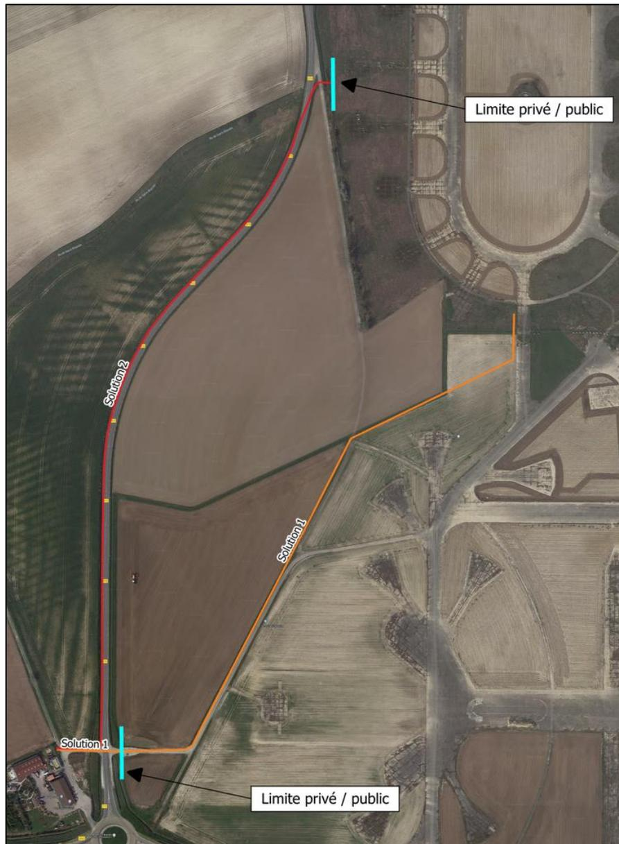
Figure 3 : 2 solutions de raccordement au réseau AEP
