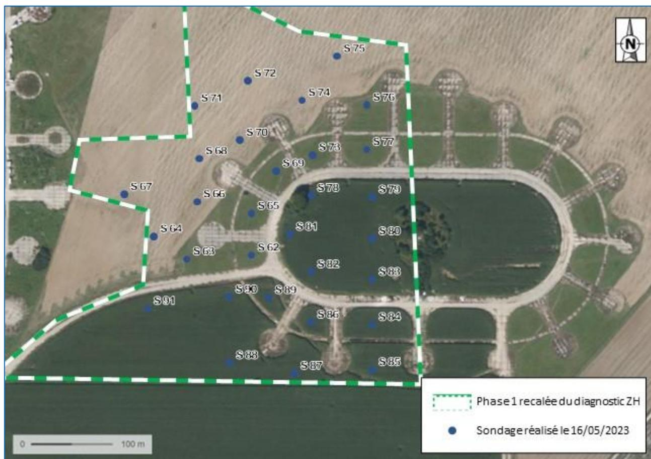
**Figure 13 : Localisation des 30 sondages à la tarière manuelle réalisés par GINGER BURGEAP le 16/05/2023 (Source : BD Ortho de l'IGN)**
