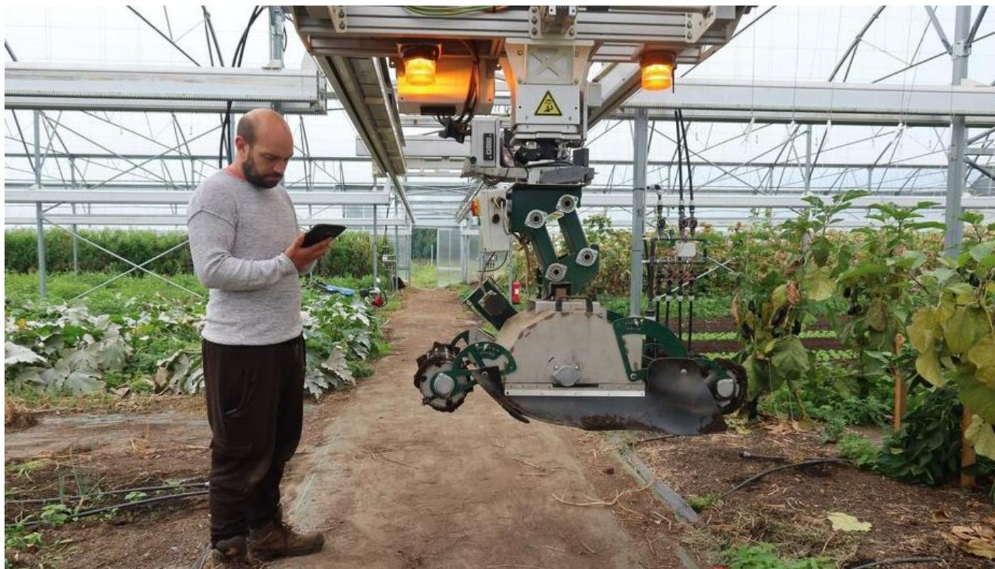
Figure 2 : maraîcher utilisant le robot équipé d'un motoculteur, à Lagny-Le-Sec
