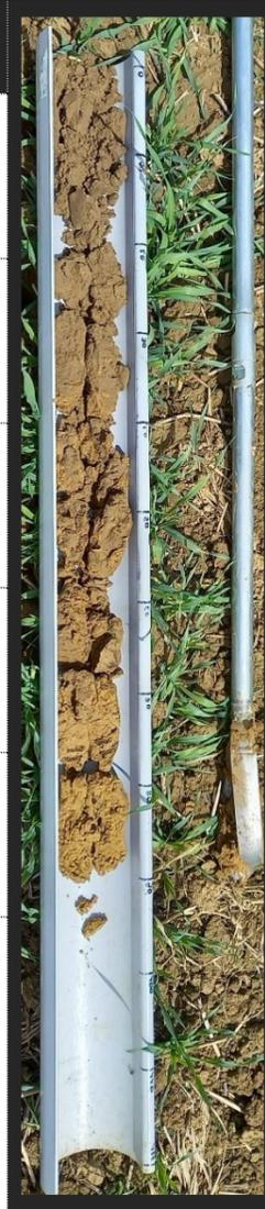
**En synthèse, les 22 sondages réalisés montrent que les sols font partie des classes de sol IIIb ou IVc non caractéristiques de zone humide.**
