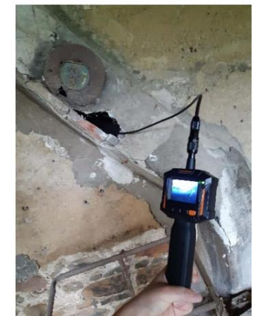
Figure 20 : Vérification des cavités à l'endoscope © EODD, 2021
