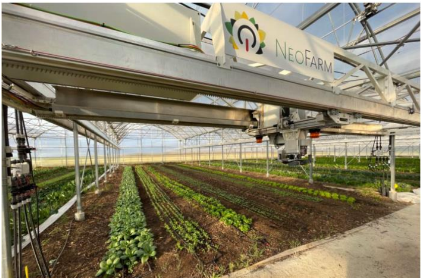
Figure 10 : Robot "portique" à Garancières-en-Beauce (Sources : NeoFarm)
