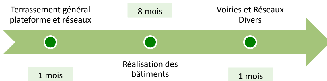
Figure 17 : Principales étapes du programme de travaux
