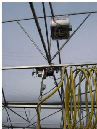
Figure 11 : Chariot d'arrosage automatique
