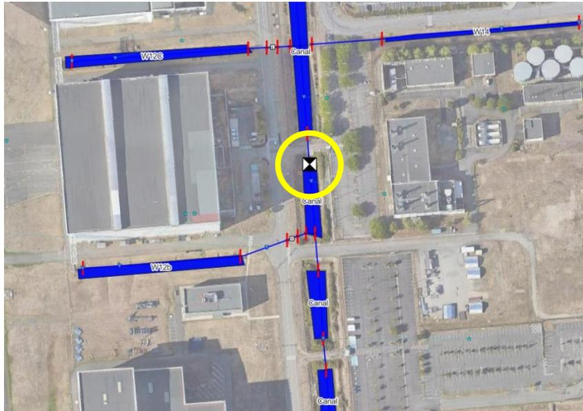
Figure 38 : Localisation du rétrécissement de section ajouté sur la branche Est
