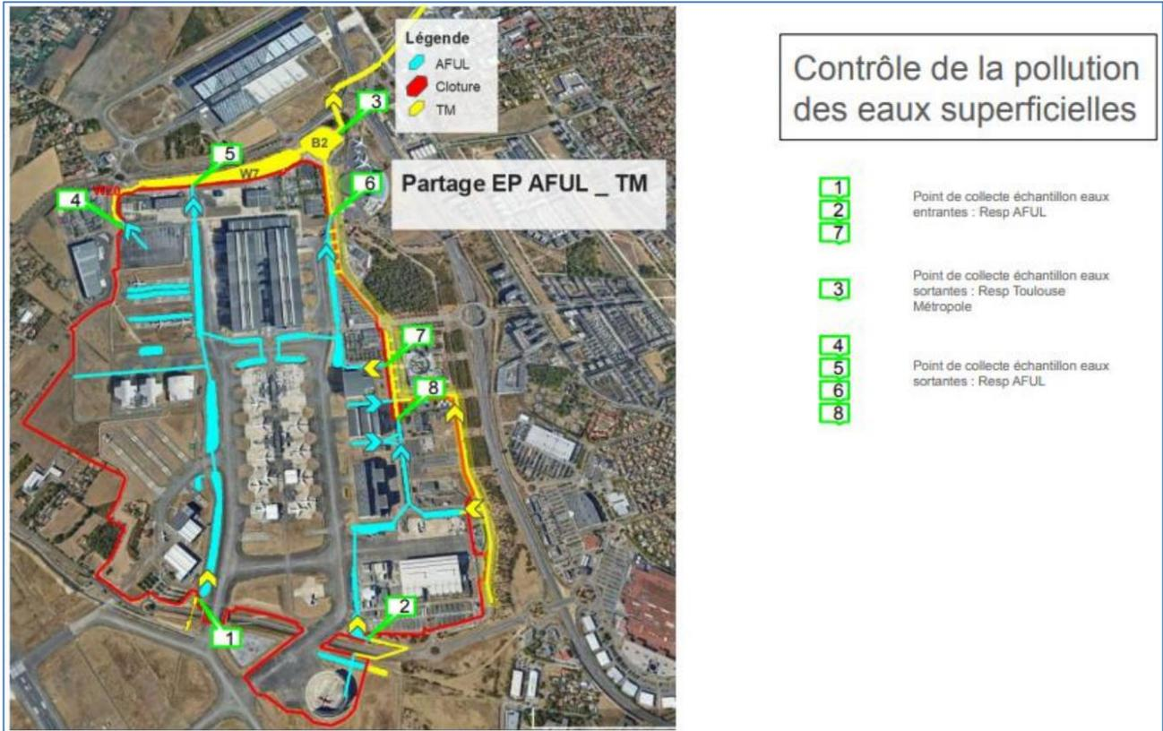
Figure 41 : Implantation des futurs points de contrôle de la pollution des eaux superficielles
