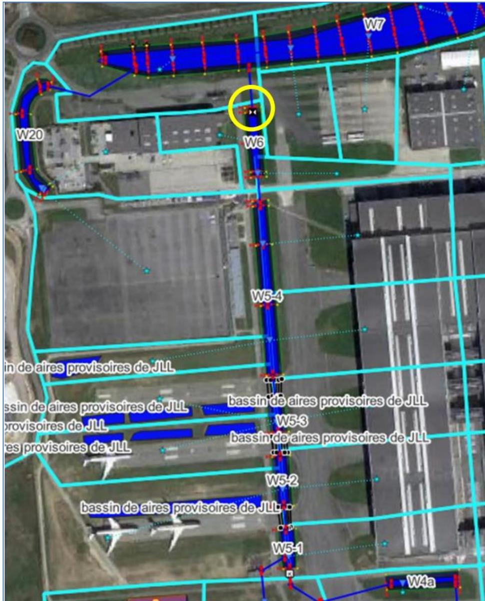
Figure 44 : Localisation de la vanne ajoutée sur le réseau en aval de W6
