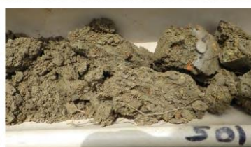
Traces rédoxiques peu marquées entre 30 et 50 cm
