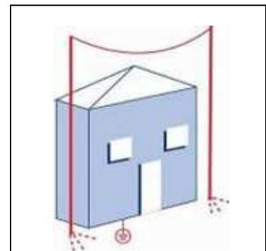
**Nota :** la protection isolée peut également être réalisée au moyen d'un ou plusieurs paratonnerres (tige simple ou paratonnerre à dispositif d'amorçage) positionnés sur des mâts situés à proximité de la zone à protéger.
