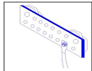
D'une façon générale, les différentes prises de terre sur le site doivent être interconnectées entre elles et les structures métalliques reliées à la terre, l'objectif recherché étant lorsque le bâtiment est directement atteint par la foudre d'éviter l'apparition de différences de potentiel dangereuses susceptibles de provoquer des incendies ou des explosions.
