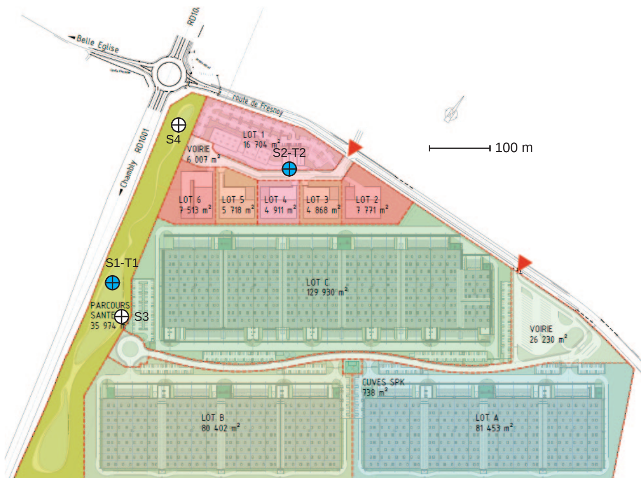
Figure 16 : Emplacement des sondages et tests d'infiltration complémentaires
