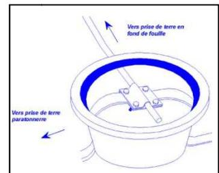
Dans le cas où le circuit à fond de fouille ne serait pas identifiable lors des travaux de terrassement, la prise de terre paratonnerre est interconnectée sur la barrette de terre la plus proche.
