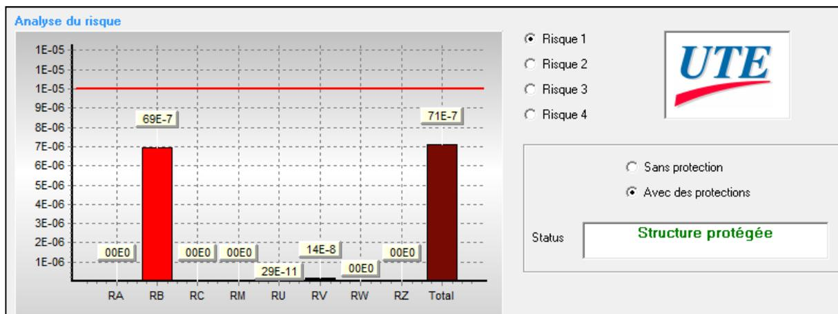
Le diagramme ci-dessus montre que la mise en œuvre d'un système de protection contre la foudre, de niveau IV minimum, abaisse le risque de perte de vie humaine R1 à une valeur égale à  $0,71.10^{-5}$ ; valeur inférieure au risque tolérable RT fixée à  $10^{-5}$ .
