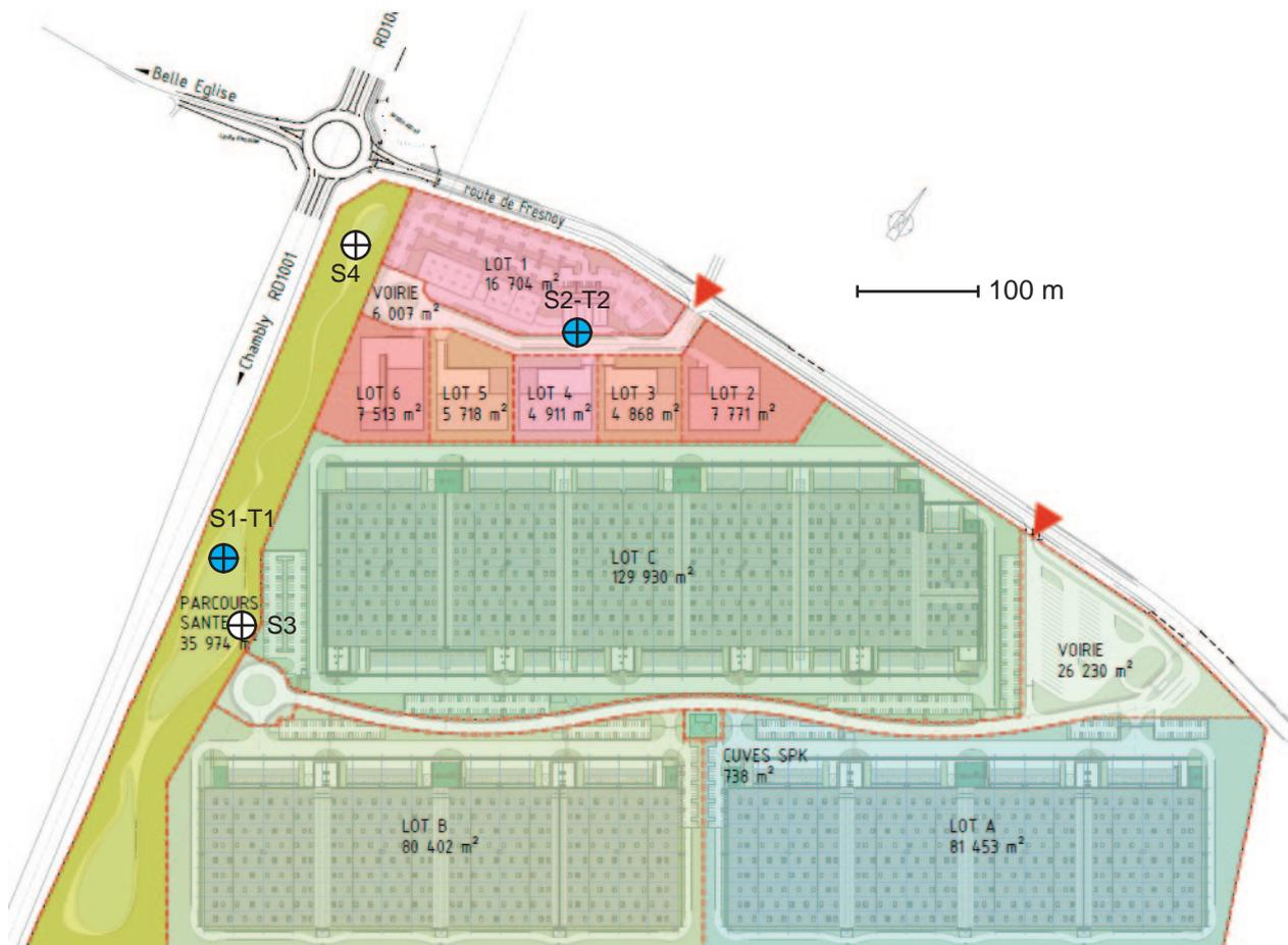
Figure 16 : Emplacement des sondages et tests d'infiltration complémentaires
