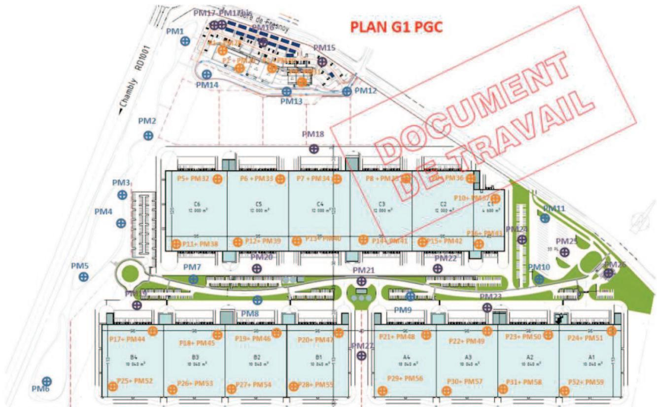
Figure 15 : Plan d'implantation des sondages et tests d'infiltration de l'étude géotechnique
