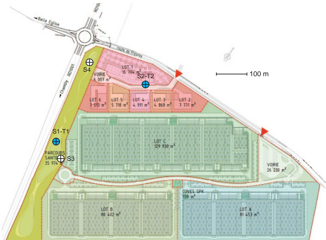
*Emplacements des sondages et tests d'infiltration complémentaires*
