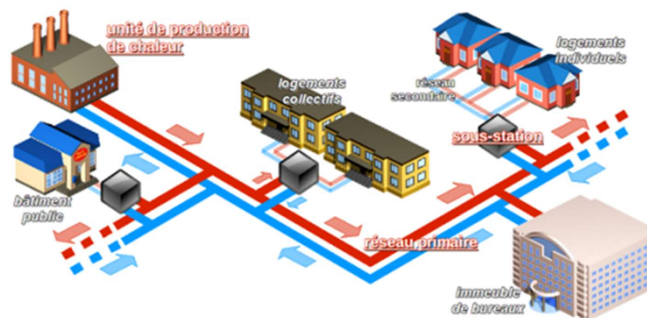
Figure 86 : Principe de fonctionnement d'un réseau de chaleur
