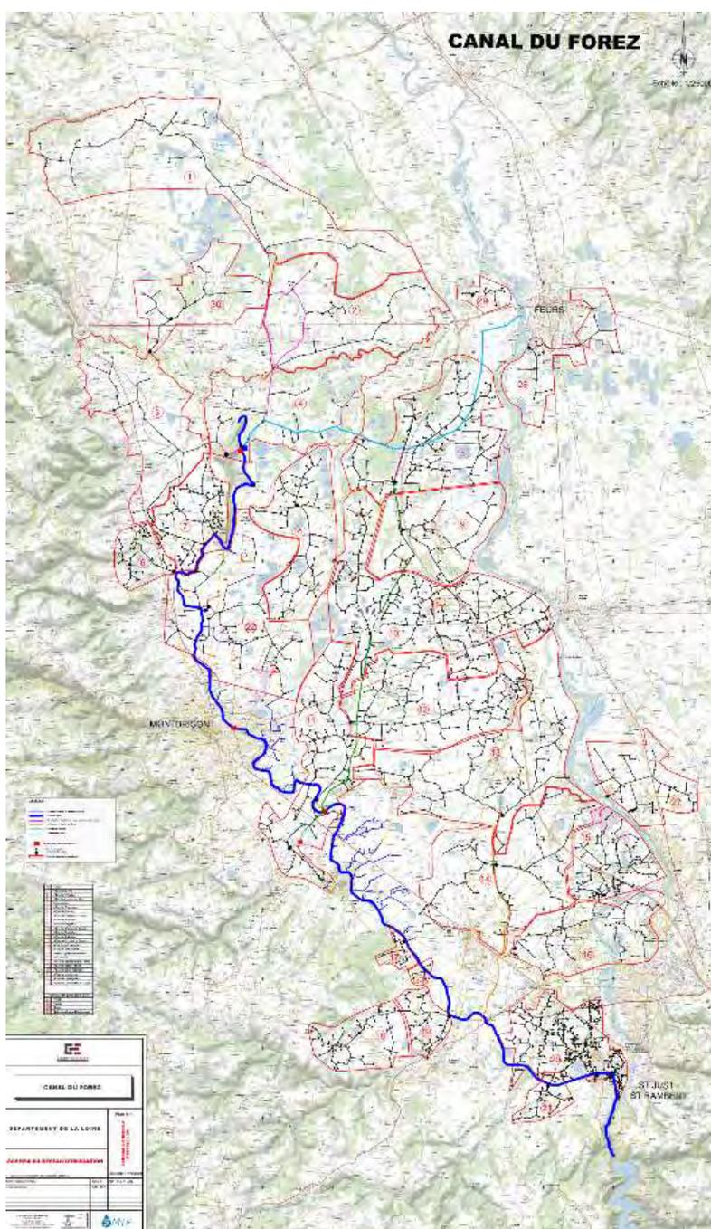
**Le territoire couvert par le canal représente une superficie de 28 000 ha** : 17 stations de pompage et 500 kilomètres de canalisations sous pression permettent **d'irriguer plus de 6 500 ha d'espaces agricoles** pour plus de **600 exploitations agricoles** par 22 périmètres d'irrigation collective.
