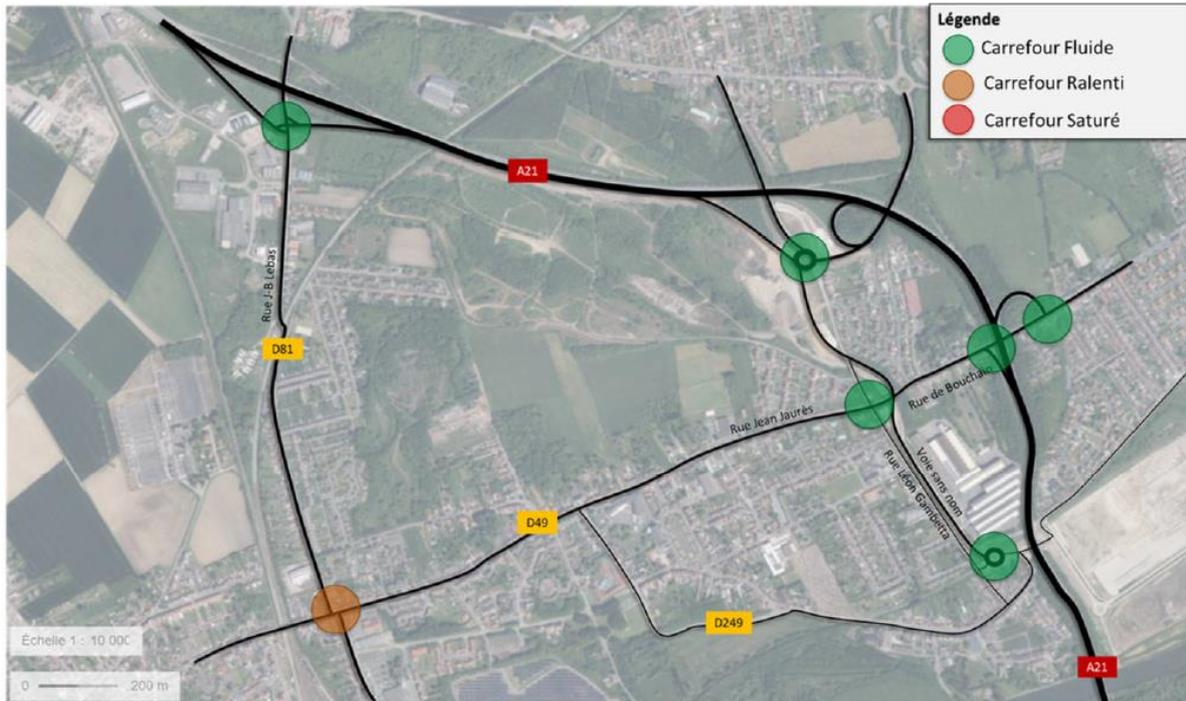
Figure 91. Conditions de circulation actuelles au carrefour, source : CAPH
