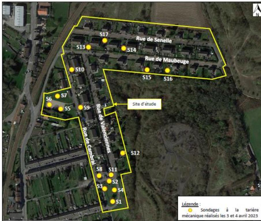
Figure 12. Plan de localisation des sondages, source : Géaupole
