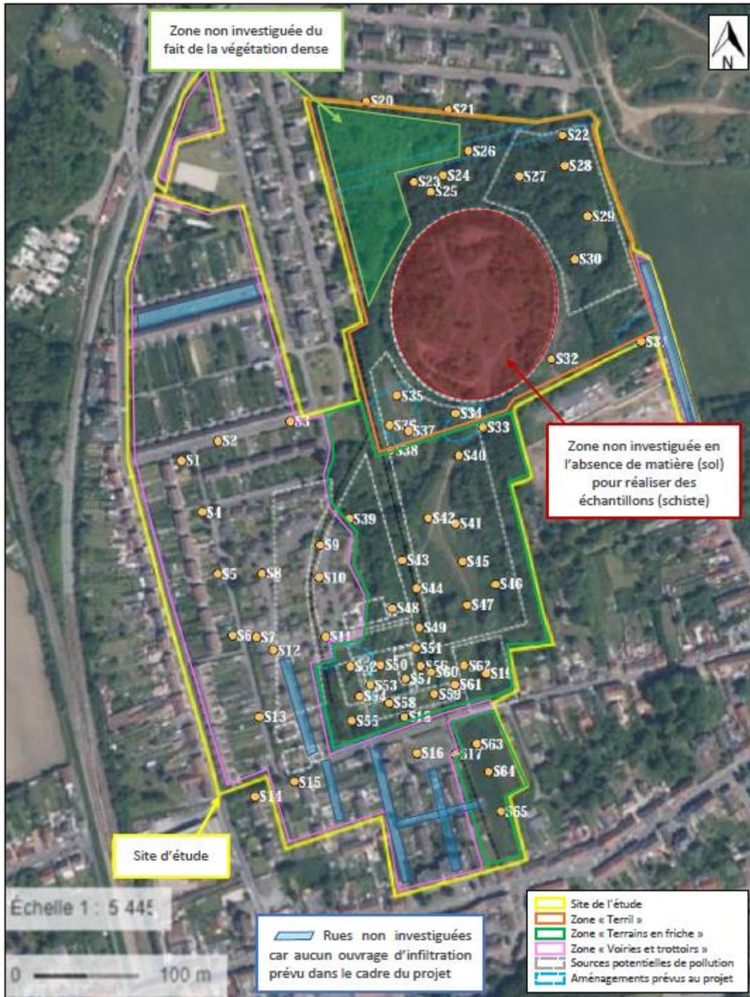
Figure 14: Plan d'implantation des sondages
