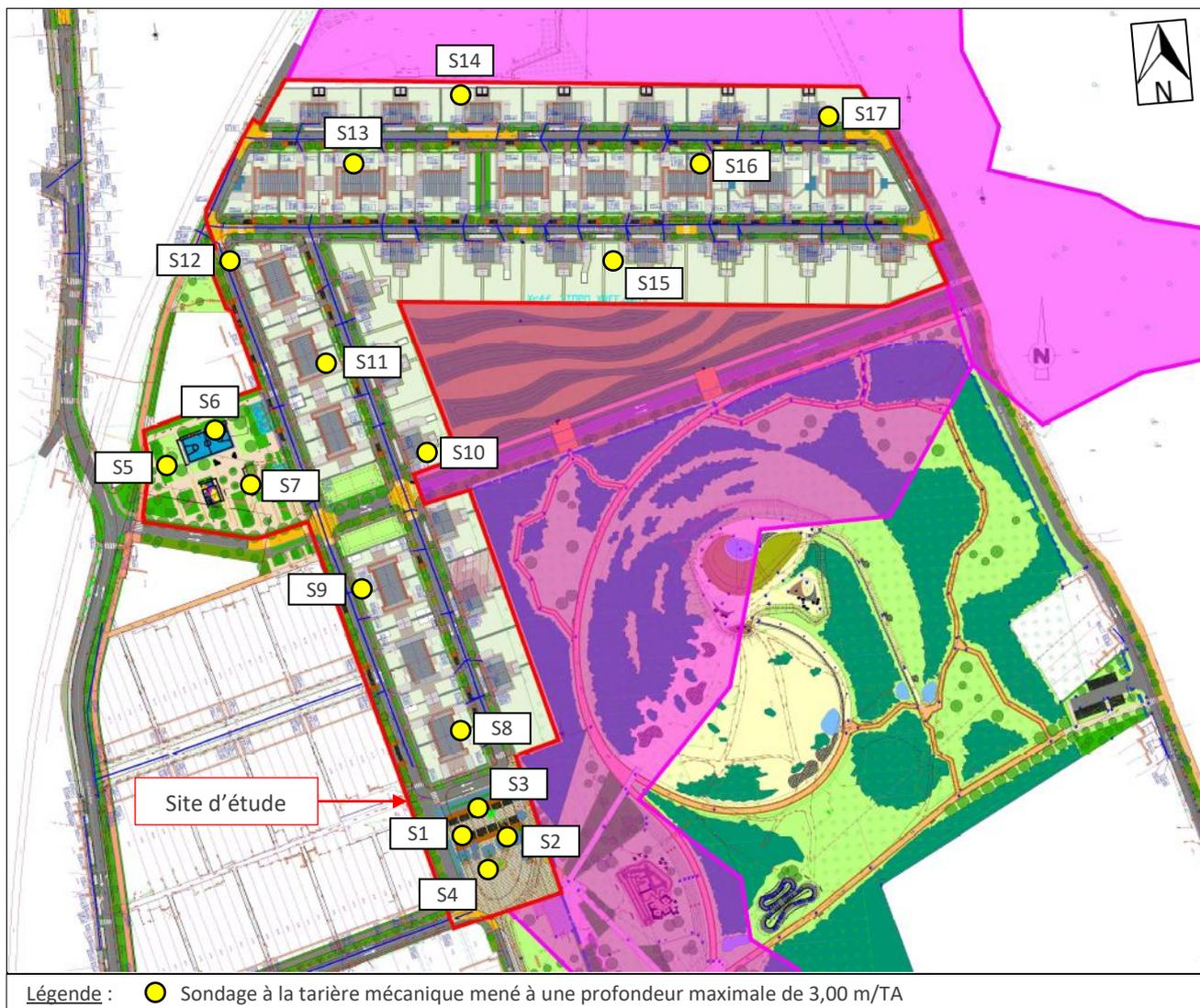
Figure 19 : Plan d'implantation prévisionnel des sondages sur plan projet
