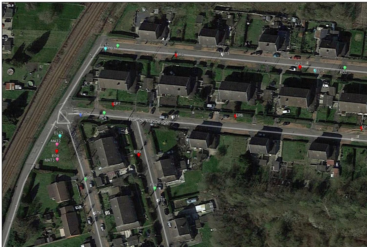
Pz : Pose d'un piézomètre / ST : Sondage à la tarière / EL : Essai LEFRANC / PD : Essai au pénétromètre dynamique / EP : Essai PORCHER / MAT : Essai MATSUO
