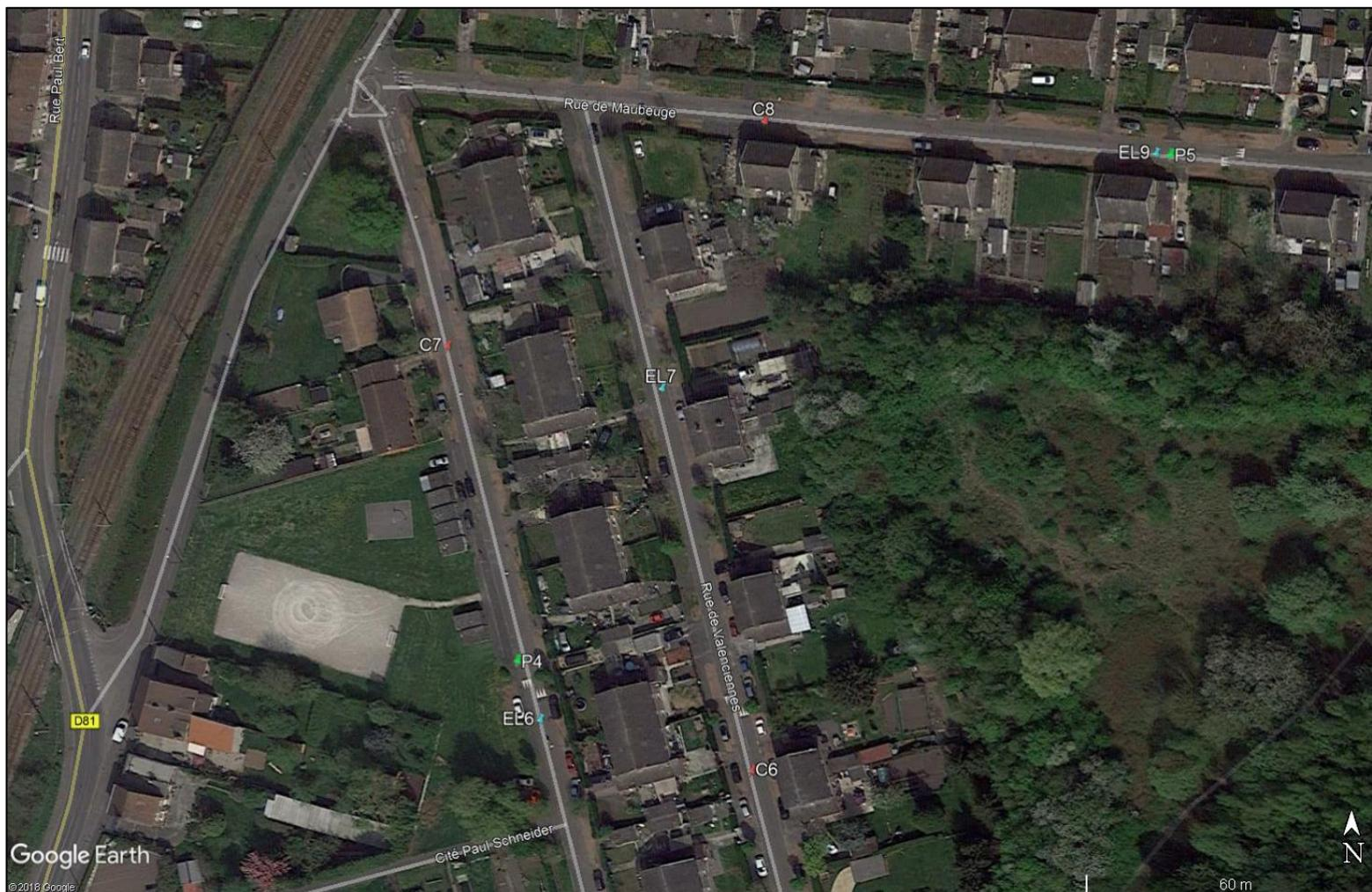
⊕ Emplacement des sondages / EL : Essai LEFRANC / P : Prélèvement à la tarière / C : Carottage de chaussée
