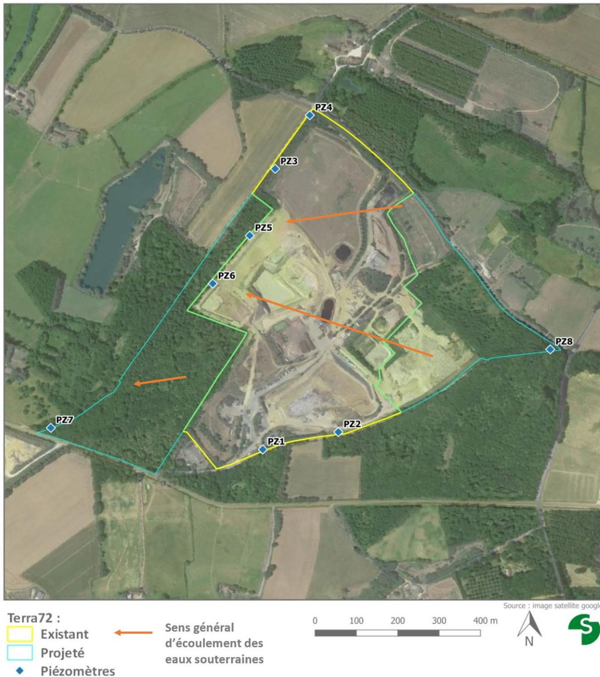
Figure 9 : Emplacement des piézomètres de surveillance Terra72
