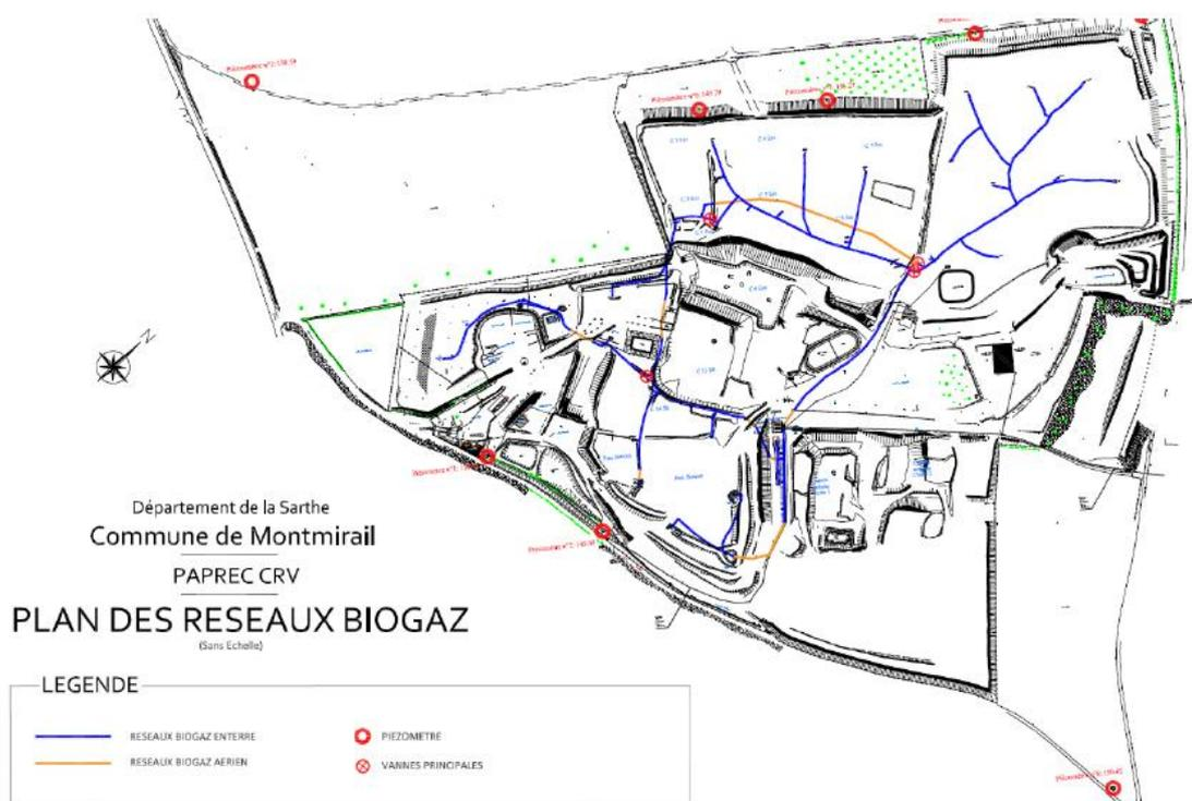
Figure 2 : plan du réseau de biogaz -site actuel
