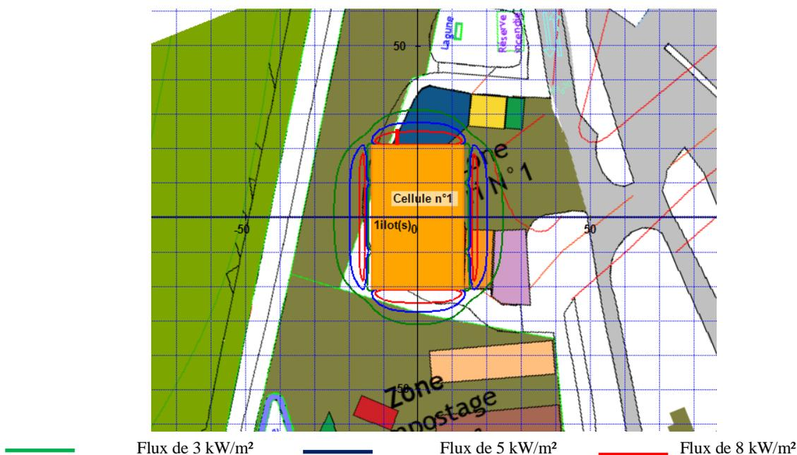
Figure 39 : Distances maximales d'effets du scénario 3a
