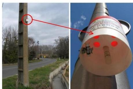
Boîte de protection avec capteurs NO<sub>2</sub> et C<sub>6</sub>H<sub>6</sub>
