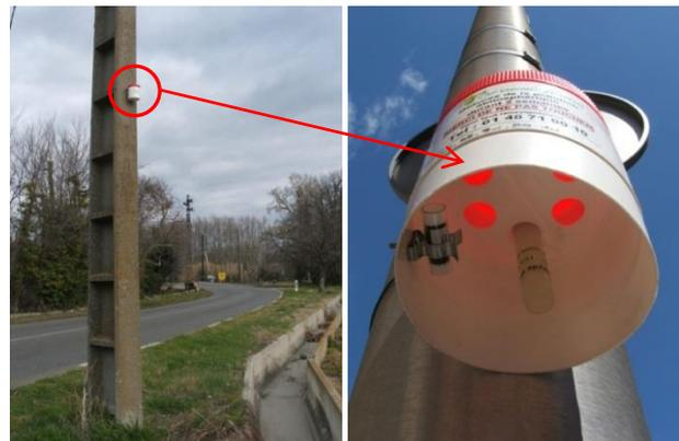
Boîte de protection avec capteurs NO<sub>2</sub> et C<sub>6</sub>H<sub>6</sub>
