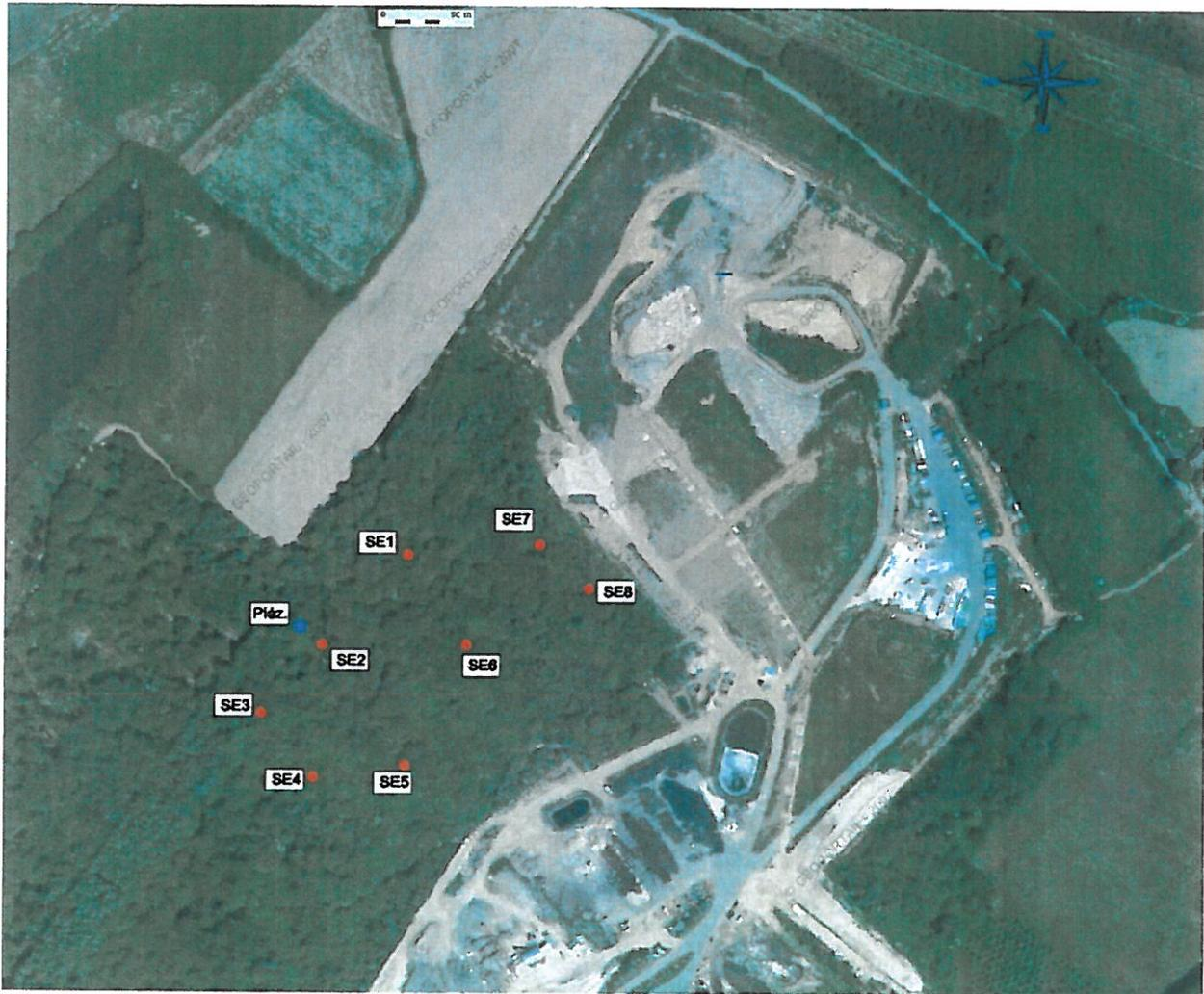
Figure 2 : localisation des sondages électriques et du piézomètre sur la photographie aérienne au 1/5 000<sup>e</sup>
