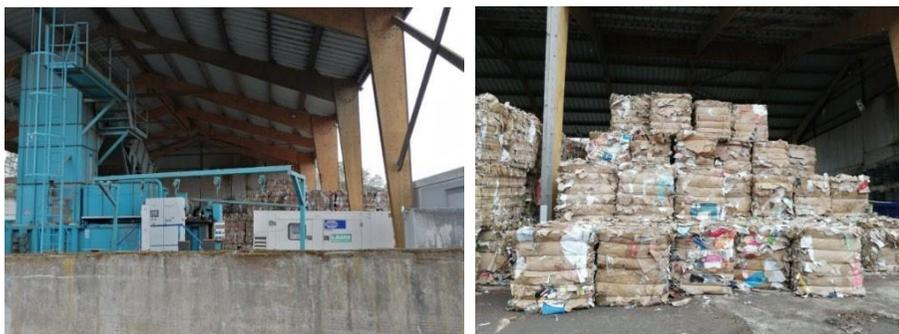
Figure 10 : Photo de la presse à balle et de balles de carton
