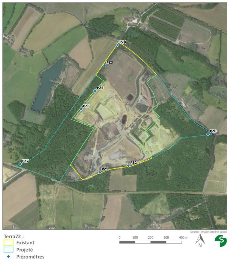
Figure 30 : Emplacement des piézomètres de surveillance autour du site de Montmirail
