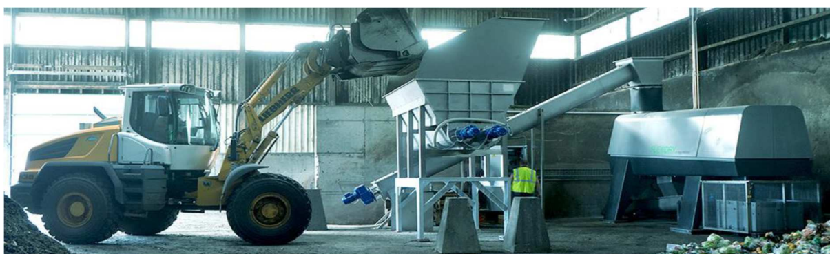
Figure 41 : Exemple de déconditionnement (alimentation du déconditionneur avec un chargeur via la trémie d'alimentation)
