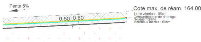
Figure 96 : Coupe de principe de la couverture finale
