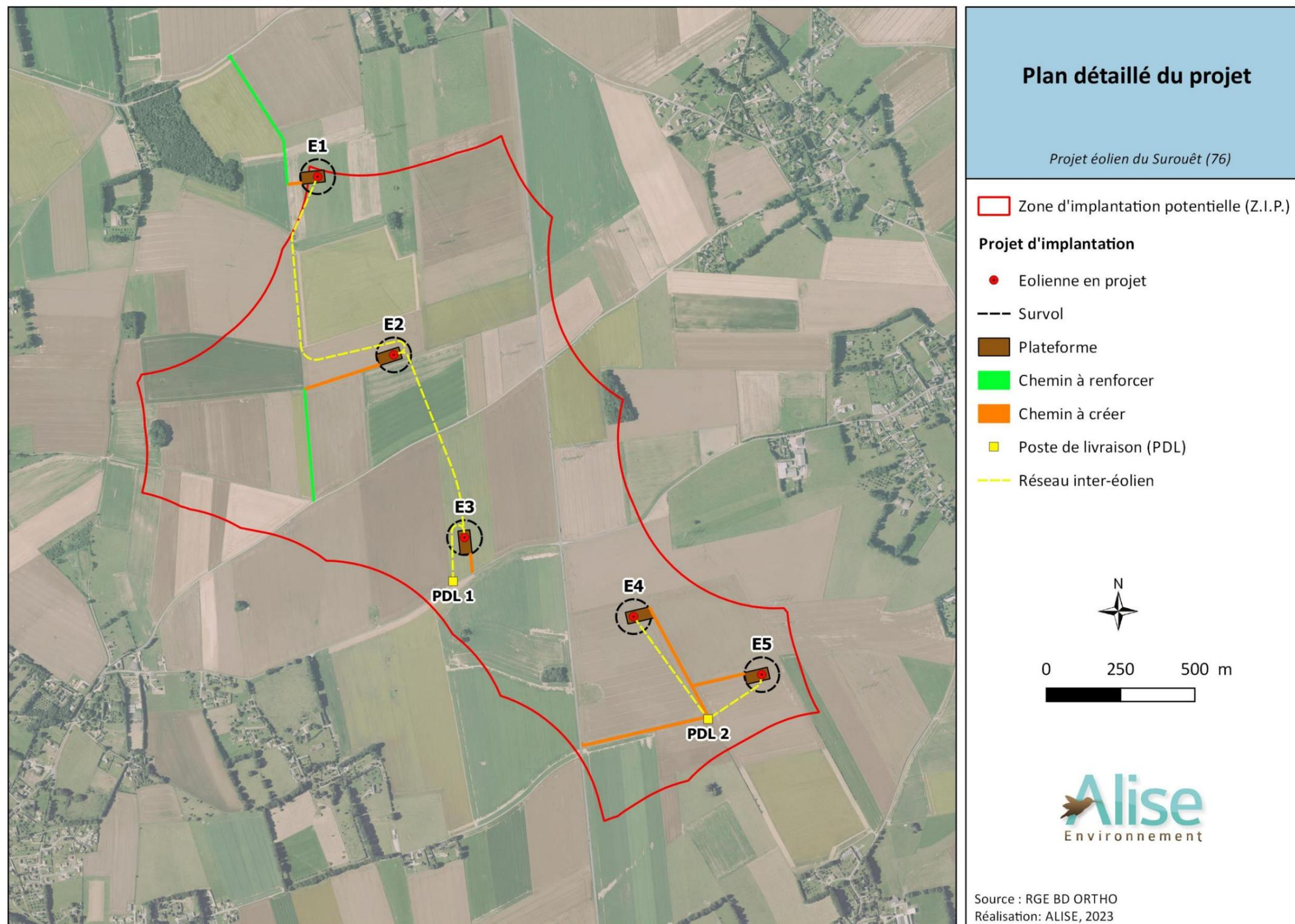
Figure 41 : Plan détaillé de l'installation
