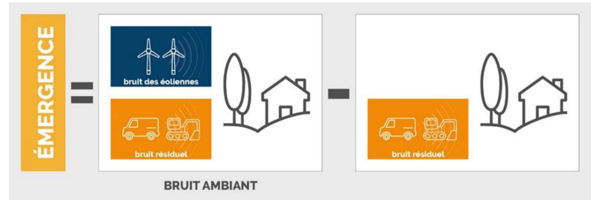
Figure 38 : Schématisation de l'émergence (source : Venathec)
