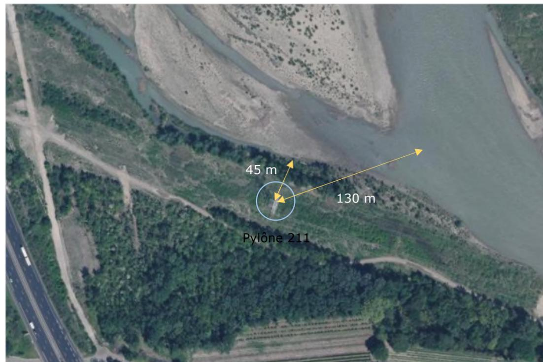
Figure 4 : Distance de 130m entre le pylône 211 et le lit vif en 2018 (Géoportail, vue d'avril 2018)
