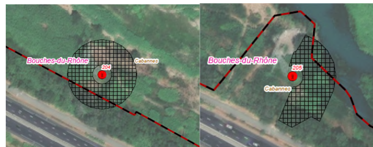
Figure 9 : Représentation en Vue en plan de la solution 1 de protection circulaire (à gauche) et de la solution 2 de raccordement sur un ouvrage de protection existant (à droite)
