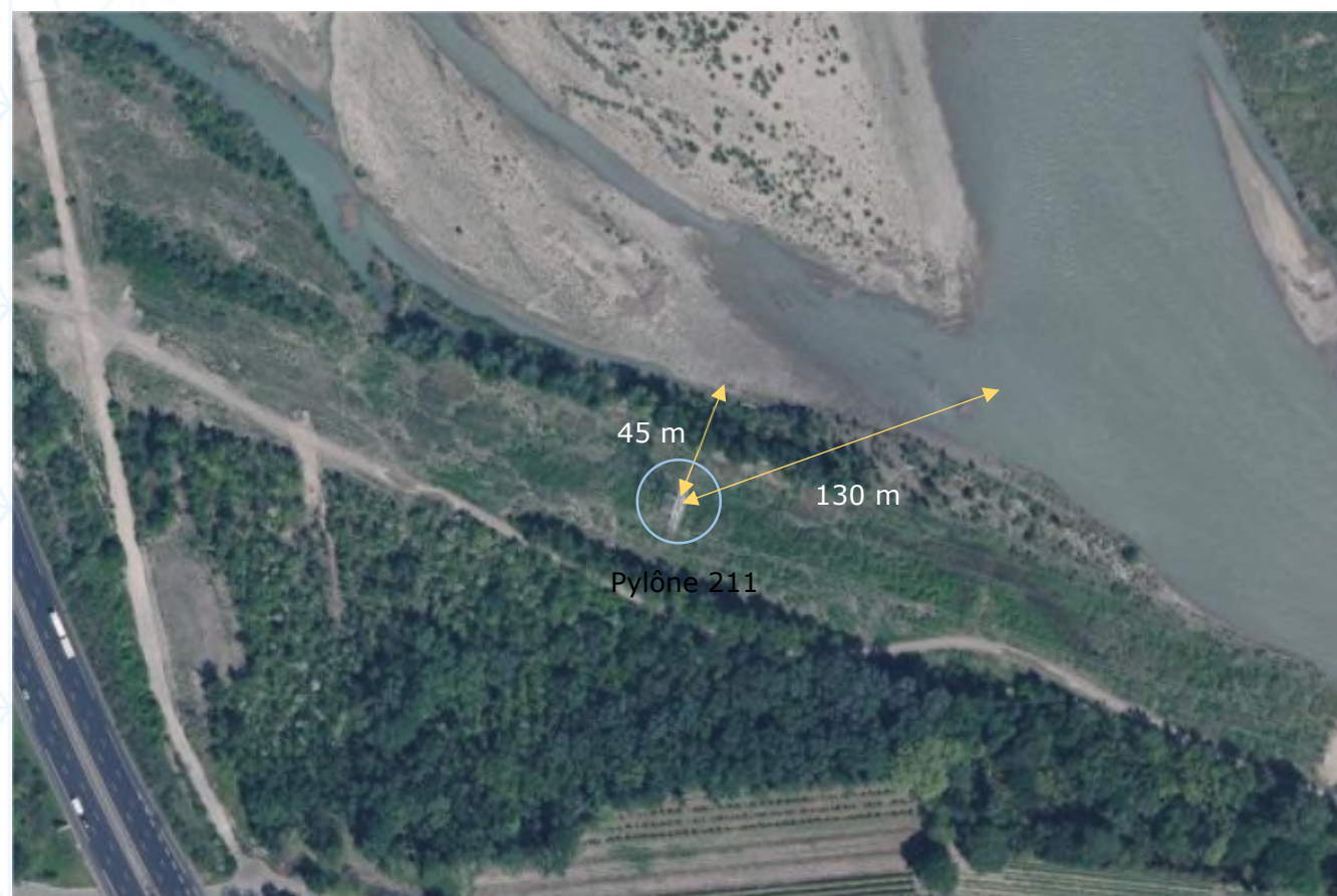
Carte 1 : Distance de 130m entre le pylône 211 et le lit vif en 2018 (Géoportail, vue d'avril 2018)
