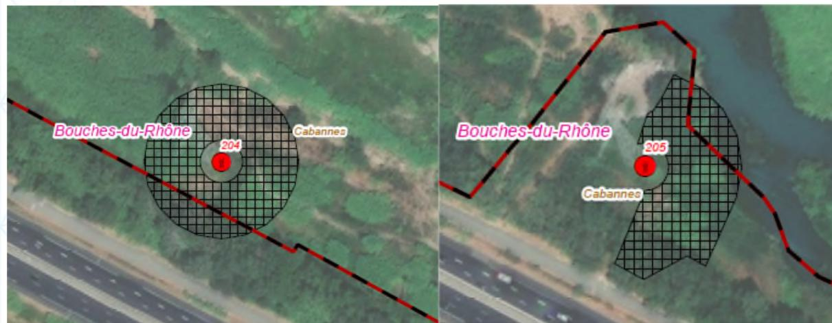
Figure 5 : Représentation en Vue en plan de la solution 1 de protection circulaire (à gauche) et de la solution 2 de raccordement sur un ouvrage de protection existant (à droite)
