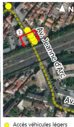
Figure 113 - Avenue Jeanne d'Arc – Etat existant – Présence de nombreuses entrées charretières côté Est de l'axe, dont l'entrée ou la sortie nécessite une manœuvre en marche arrière.
