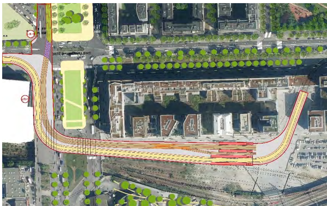
Figure 23 - « VARIANTE D' – DOCP » - Terminus du T8Sud sur le parvis de la gare Rosa Parks après élargissement du tunnel du T3b inversant le positionnement des stations T3b et T8 (DOCP 2019)
