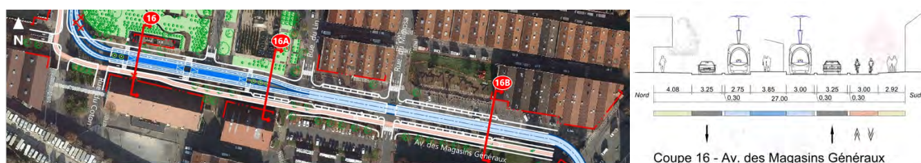
Figure 44 - Plan et coupe de la variante d'insertion avec station « centrale » à deux quais dans le prolongement l'un de l'autre
