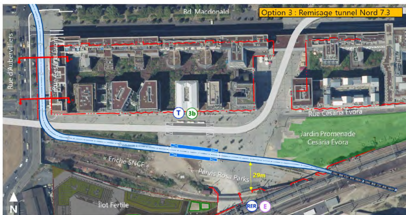
Figure 30 – Variante « Cesária Évora » : arrière-gare dans le tunnel 7.3 (EGIS, 2021)
