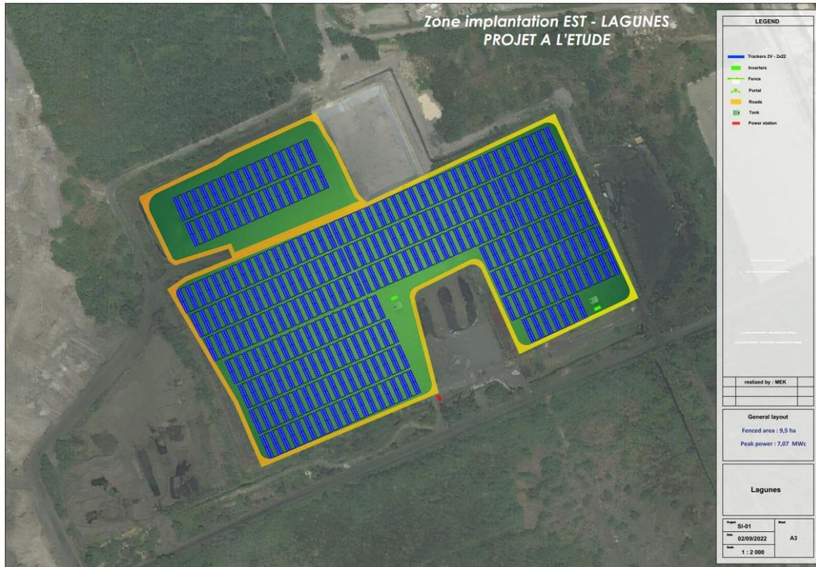
Figure 10 : Implantation prévisionnelle des panneaux photovoltaïques sur les lagunes L1, L2, L4, L5, L6 et L7 - projet susceptible d'évoluer et présenté ici à titre indicatif (Source : QAIR, janvier 2023)
