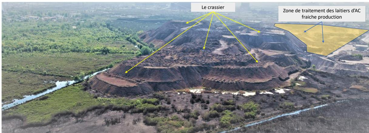
On y voit aussi la zone de traitement des laitiers d'AC (déferrisation...). Les scraps (partie non ferreuse des laitiers) sont entreposés côté Sud du crassier jusqu'à leur valorisation par l'équipe Coproduits du site.
