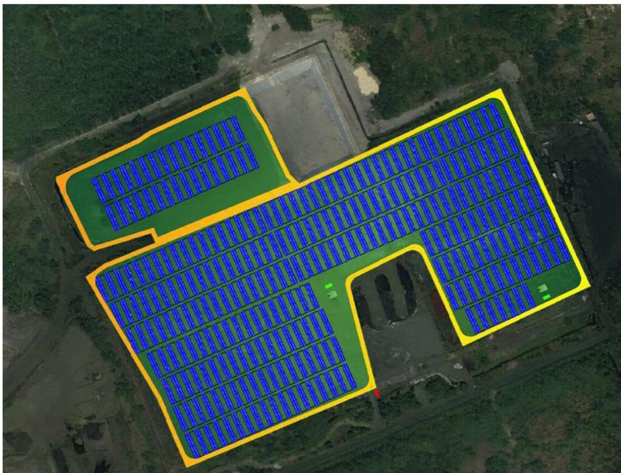
**Figure 1 – Implantation prévisionnelle des panneaux photovoltaïques sur les lagunes (QAIR)**
