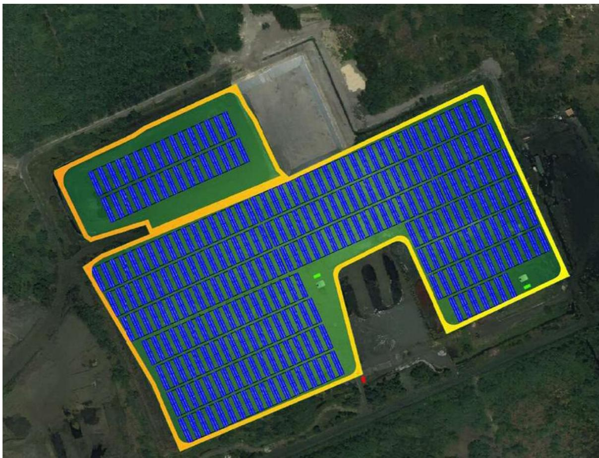
**Figure 3 – Implantation prévisionnelle des panneaux photovoltaïques sur les lagunes (QAIR)**
