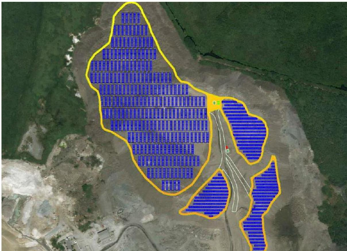
Figure 4 - Implantation prévisionnelle des panneaux photovoltaïques sur le Crassier (QAIR)
