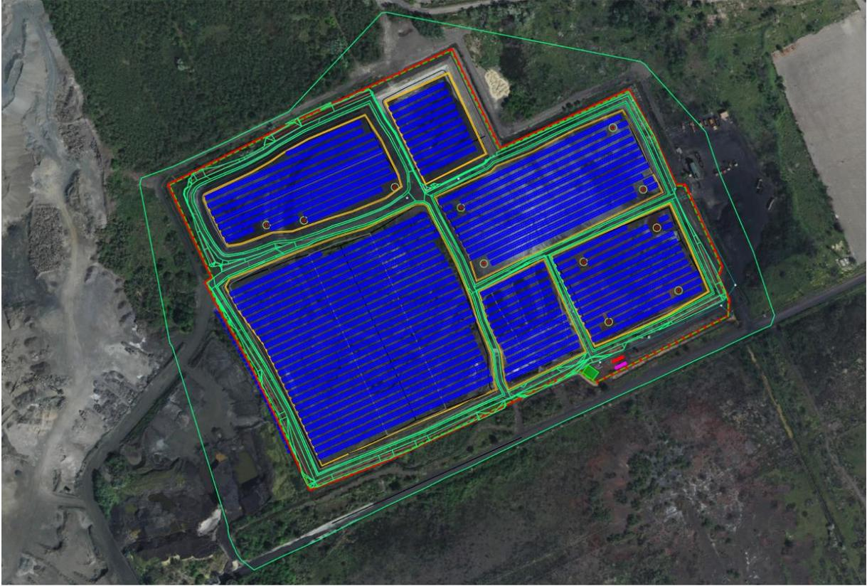
*Figure 4 - Plan de masse final du projet photovoltaïque sur le secteur des Lagunes*
