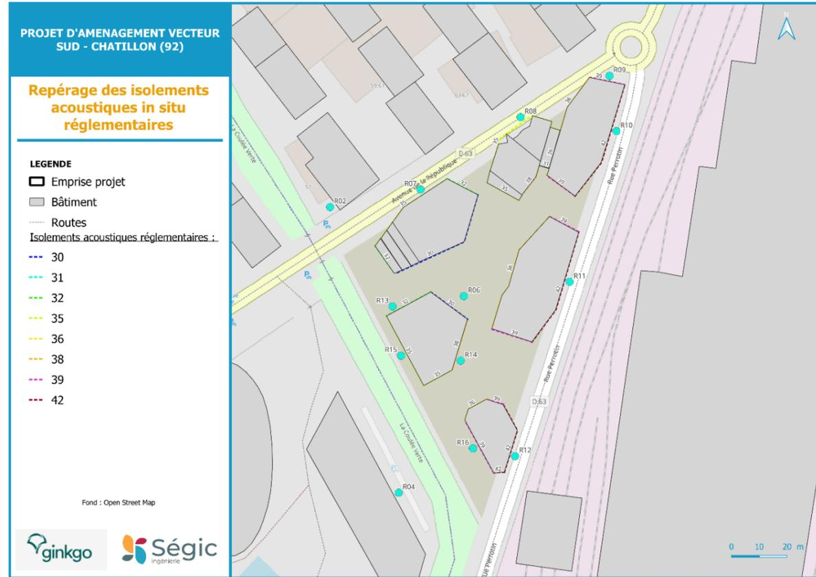
Figure 30 : Repérage des isolements acoustiques in situ réglementaires (Source : Ségic Ingénierie)
