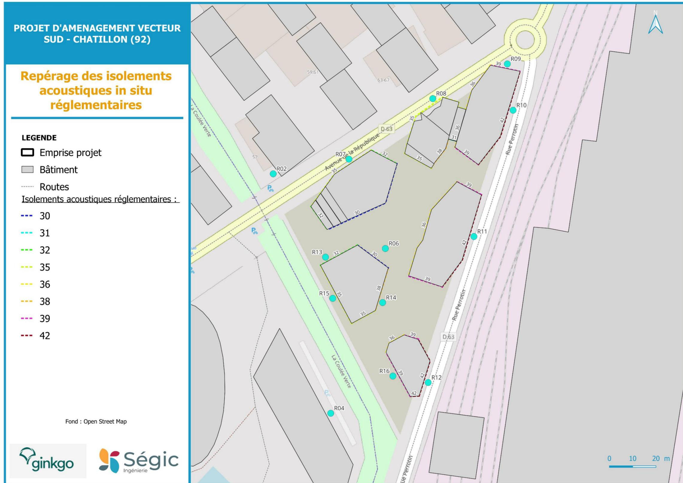
Figure 28 : Repérage des isolements acoustiques in situ réglementaires (Source : Ségic Ingénierie)
