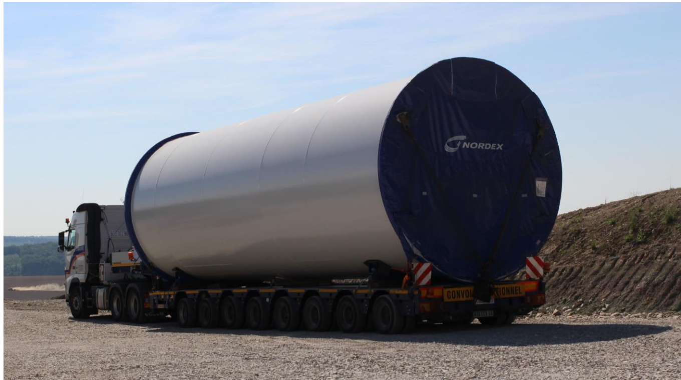
Photo 7 : Transport d'une section de mât d'éolienne
