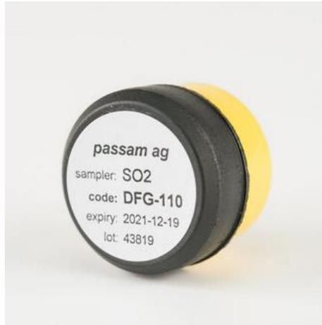
Figure 3 : Illustration de l'échantillonneur passif Passam pour le SO<sub>2</sub>
