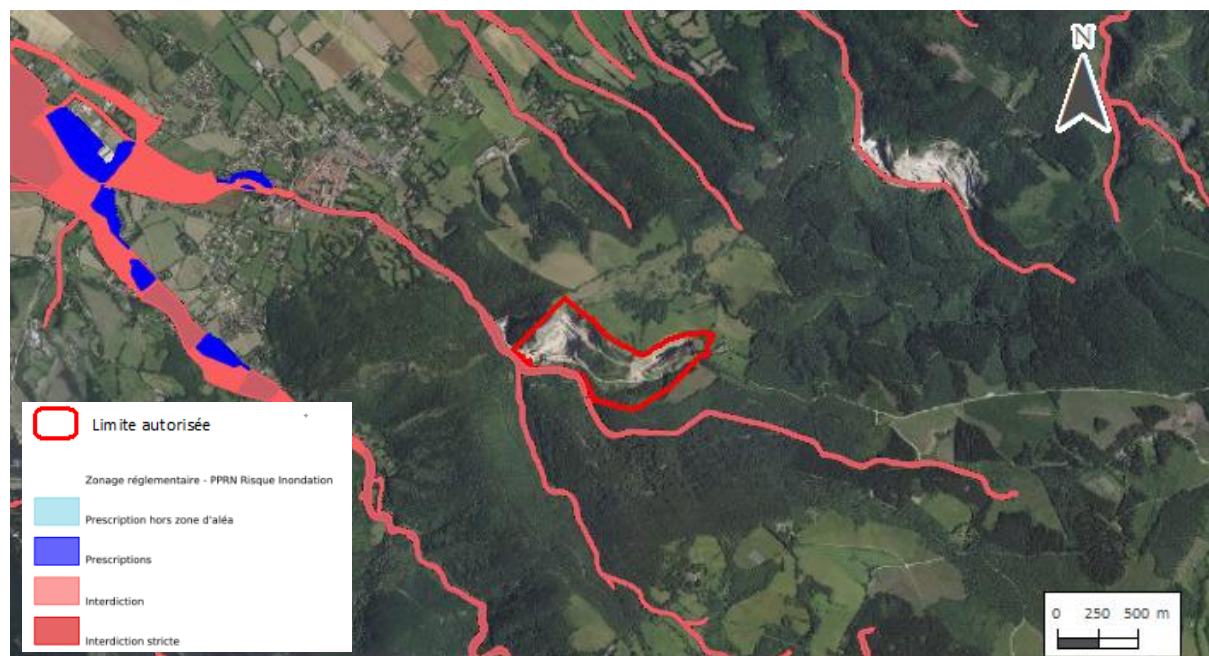
Figure 7 : Zonage réglementaire - PPRN risque inondation au droit de la carrière de Sorèze (source : Géorisques.fr)
