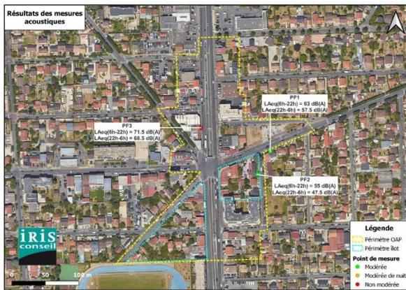
Figure 8 : Résultats des mesures acoustiques in situ – Source : IRIS Conseil
